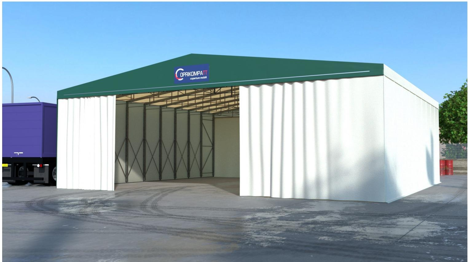
La tendo copertura **COPRITUTTO®**, modello standard, è una struttura autoportante retraibile composta da coppie di montanti sopra i quali sono fissate delle capriate a traliccio attraverso piastre imbullonate con bulloneria di tipo 8.8 e dadi. I montanti in
